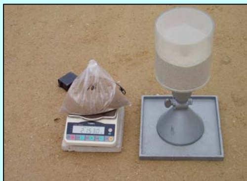
現場密度試験(砂置換法)
