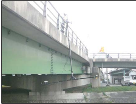
先端に装着したビデオカメラによって撮影を行う。
